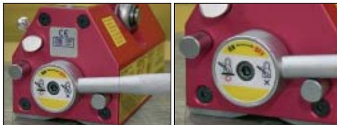
Figura 18: detalhe do acionamento (alavanca) dos levantadores magnéticos.
