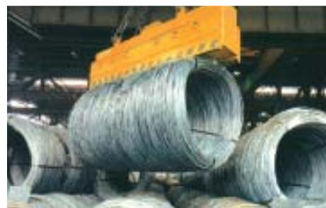
Figura 1: eletroímã retangular de campo profundo para transporte de bobinas de fio máquina.
