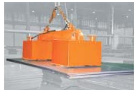
Figura 6: eletropermanentes usados para o transporte de chapas.
