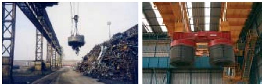
Figura 21: eletroímãs circulares em operação.
