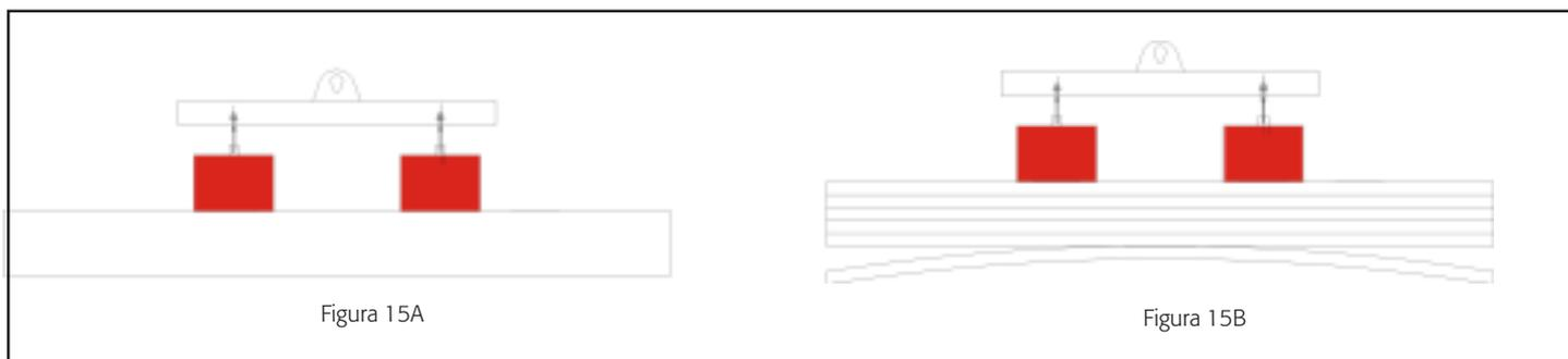
Figura 15A: barra de carga com 2 equipamentos magnéticos para transporte de chapas "grossas".
