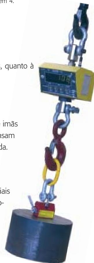
Figura 3: levantador magnético de 100Kg transportando peso de 108Kg (peso mostrado no visor da balança suspensa).
